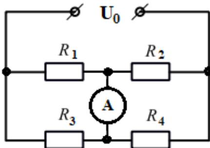
При включенном амперметре сопротивление цепи:
