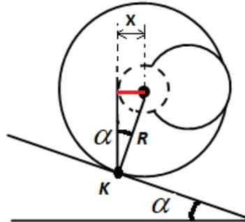
Очевидно, что устойчивое положение невозможно, и цилиндр начнет скатываться без проскальзывания, если вертикаль, проходящая через точку  $K$  касания цилиндра с доской, не пересекается с этой окружностью. В этом случае момент силы тяжести относительно точки касания цилиндра с доской не может быть равен нулю ни при каком положении цилиндра. Таким образом, угол, при котором цилиндр начнет скатываться, равен:
